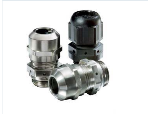
VentGLAND* ventilační kabelová vývodka s kompenzací tlaku, proti kondenzování vody
